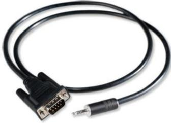
Le câble série Global Caché Flex Link (RS232) se connecte à votre module iTach Flex via la prise jack 3,5 mm pour permettre le contrôle IP/WiFi des composants série RS232. Conçu comme une solution RS232 totale, le câble détecte automatiquement si vous avez besoin d'une connexion croisée ou directe, puis commute pour s'adapter à votre application. Il est également livré avec un changeur de genre pour s'adapter aux connexions masculines et féminines.
