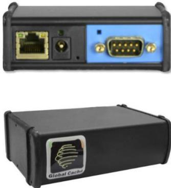
Transformez vos appareils contrôlés en série (RS232) en appareils de contrôle à distance en les connectant à Internet à l'aide du Global Caché iTach pour les appareils série (filaire). L'iTach dispose de ports pour jusqu'à trois périphériques série et se connecte à votre réseau domestique via Ethernet, permettant un contrôle IP via une variété d'interfaces. Doté d'une large compatibilité, l'iTach peut intégrer vos périphériques série dans presque tous les systèmes tiers connectés au réseau.
