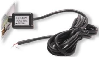
Le capteur d'entrée de tension AC/DC de Global Caché surveille l'état marche/arrêt des composants électroniques en détectant une tension AC ou DC supérieure à +/- 2V. Des tensions allant jusqu'à +/- 24 V peuvent être connectées au capteur de tension pour déterminer l'état d'alimentation de l'équipement, des multiprises (via un adaptateur mural) ou la condition de « sonnerie » d'un circuit téléphonique.
